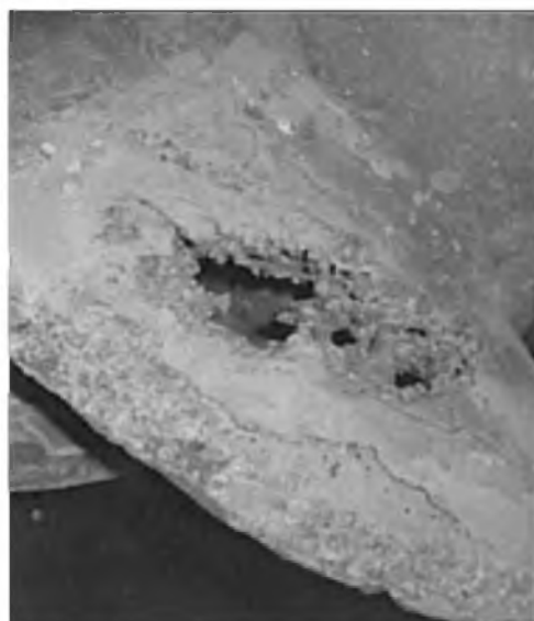
Rys. 20.4 Wirnik pompy przed regeneracją
