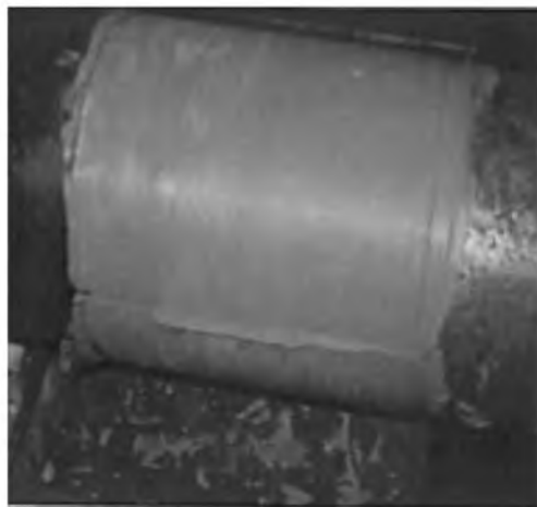
Rys. 20.3 Wygląd czopa wału po regeneracji
