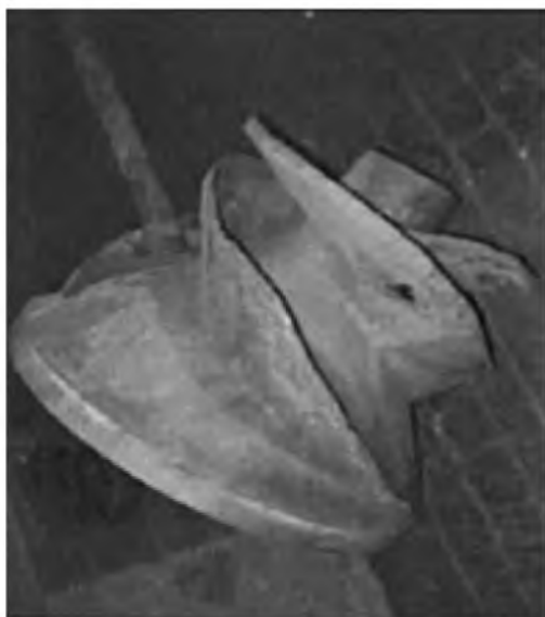
Rys. 20.4 Wirnik pompy przed regeneracją
