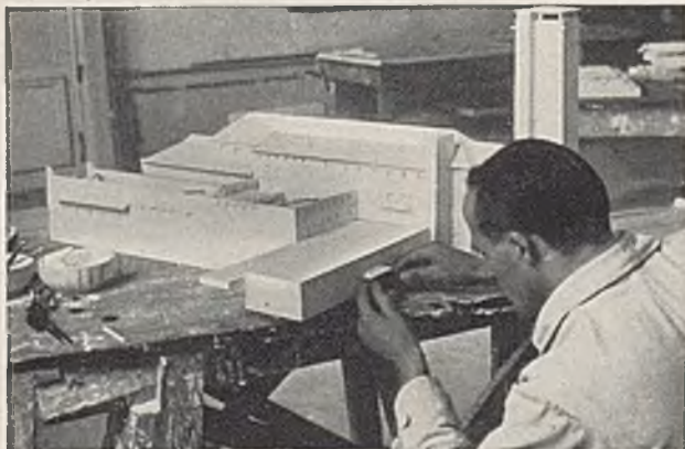
Abb. 7 (links). Die innen durch Draht, Metallklammern oder Gipsstützen versteiften Platten sind bereits zu standfesten Raumkörpern „montiert“. Die Oberflächenbehandlung (Darstellung von Steinfugen usw.) wird fortgesetzt. Abb. 8 (rechts). Das Modell ist fertig zusammengestellt und erhält seinen letzten „Schliff“.
