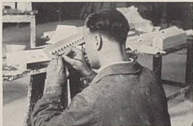
Abb. 5 (links). Das durch den Guß entstandene Positiv wird weiter bearbeitet; hier ist die Fertigstellung einer Kassettendecke gezeigt. Abb. 6 (rechts). Jeder einzelne Architekturteil, ob gezogen oder gegossen, erhält mit Hilfe verschiedener Werkzeuge seine Ausgestaltung und Verfeinerung. Hier wird die Gaupenreihe eines Daches überholt.
