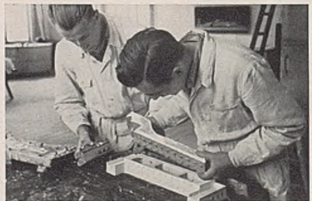
Abb. 3 (links). Um das Gewicht des Positivs zu verringern, werden durch Herausschneiden überflüssiger Masse Hohlräume geschaffen. Bei gehobener Deckelplatte wird die Festigkeit des Gipses geprüft. Abb. 4 (rechts). Der Gips hat seinen letzten Härtegrad erreicht, die Form wird auseinander genommen. Der Formteil, den der Bildhauer in den Händen hält, trägt als Negativ plastische Erhöhungen, die im Positiv als die Fensteröffnungen des mittleren Gebäudeteiles in Erscheinung treten.
