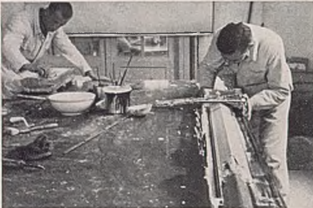
Abb. 1 (links). Der Gipszug. Mit Hilfe der Schablone werden aus der breiigen Gipsmasse die Profile eines Architekturteiles „gezogen“, hier z. B. ein langgestrecktes Satteldach der Ordensburg Vogelsang. Abb. 2 (rechts). Der Gipsguß. In die durch Schellack isolierte Negativform wird der Gips in leichtflüssigem Zustande eingegossen. Die Form besteht aus einzelnen, durch Drähte miteinander verklammerten Teilen, kann also nach Erstarrung der Gipsmasse leicht auseinander genommen werden.
