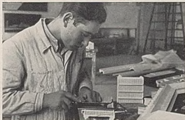
Abb. 5 (links). Das durch den Guß entstandene Positiv wird weiter bearbeitet; hier ist die Fertigstellung einer Kassettendecke gezeigt. Abb. 6 (rechts). Jeder einzelne Architekturteil, ob gezogen oder gegossen, erhält mit Hilfe verschiedener Werkzeuge seine Ausgestaltung und Verfeinerung. Hier wird die Gaupenreihe eines Daches überholt.
