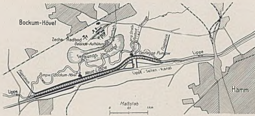
Abb. 23. Die Verlegung der Lippe westlich von Hamm am abgesunkenen Gebiete. M. 1:60 000.
