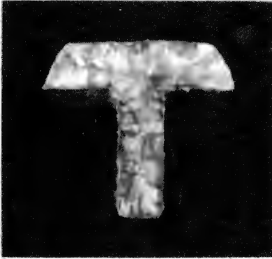
Rys. 4. Makrostruktura próbek odlanych z Al 99,7 w formie skorupowej: a) próbka wzorcowa, b) próbka odlana w WRPM; t_{od} = 10 s, f_r = 1 Hz, B = 0,04 T
