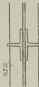
Abb. 27. Stabanschluß mit schrägen Kehlnähten und Stirnnähten.
