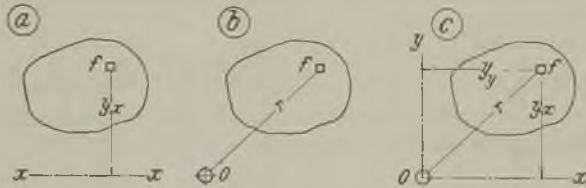
Abb. 76. Zur Bestimmung des polaren Trägheitsmomentes. J_x = \sum f y^2 ; J_y = \sum f y_y^2 ; J_p = \sum f r^2 ; womit J_p = J_x + J_y wird.
