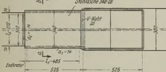
Abb. 97. Gurtplattenstoß mit Stumpfnah und Lasche.
