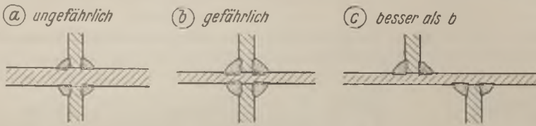
Abb. 13. Häufung von Schweißnähten.
