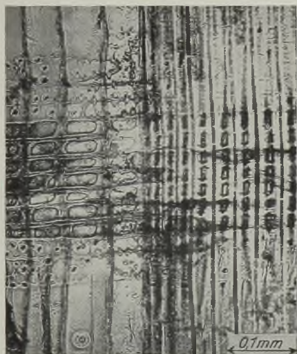
Abb. 745. Radialer Längsschnitt. Kiefernholz. Vergr. 150.
