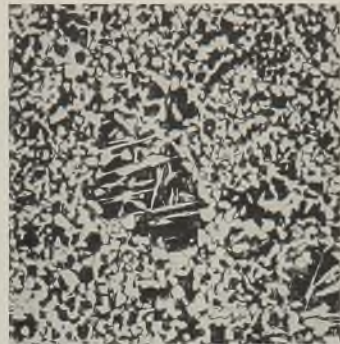
Abb. 619. Stahlguß mit örtlichem Widmannstätten-Gefüge.
