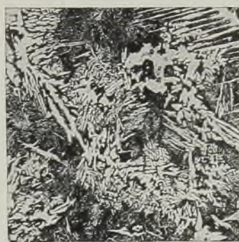
Abb. 576. Desgleichen. Ferrit IV. Vergr. 50.
