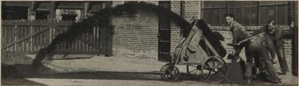
Abb. 711. Royer-Sandschleuder- und -mischapparat.
