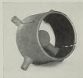
Abb. 408. Risse infolge zu harten Kerns.
