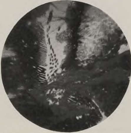
Abb. 658. Zersetztes Gußeisen. Vergr. 750.
