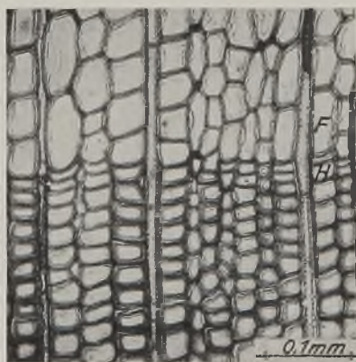
Abb. 749. Querschnitt durch Fichtenholz. Vergr. 12.
