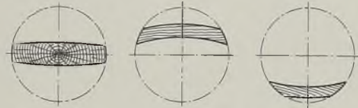
Abb. 757. Abb. 758. Abb. 759. Abb. 757—759. Verschieden geschwundene Bretter.
