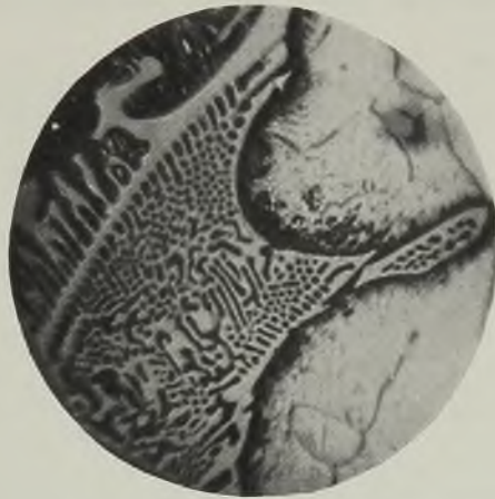
Abb. 657. Zersetztes Eisenphosphid-Eutektikum. Vergr. 750.
