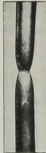
Abb. 621. Probestab mit 0,11% C, bei richtiger Temperatur (890°) gegläht.
