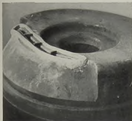
Abb. 643. Unterteilen der Schweißform.
