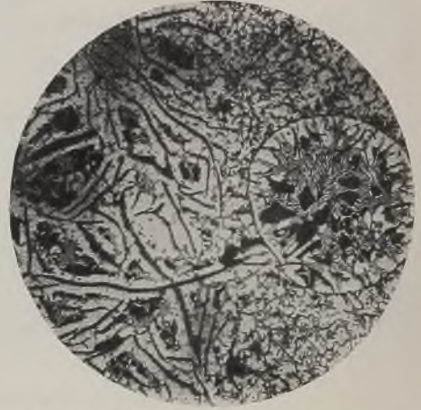
Abb. 659. Eisenkügelchen in der Schweiße. Vergr. 25.
