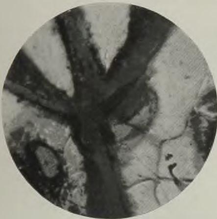
Abb. 656. Oxydiertes Gußeisen. Vergr. 750.
