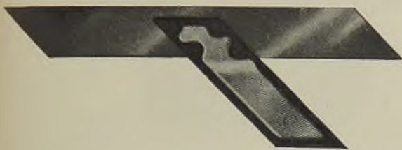
Abb. 861. Gehrungsmaß mit Stahlzunge.
