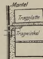
Abb. 138. Gußeiserner Stützring im Ofenmantel.
