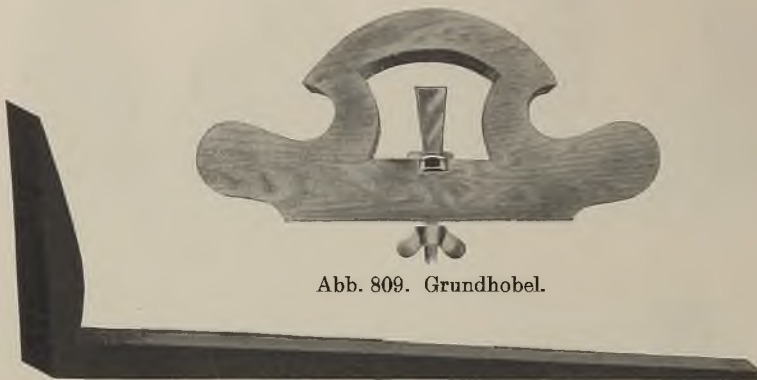
Abb. 810. Hobeisen für Grundhobel.
