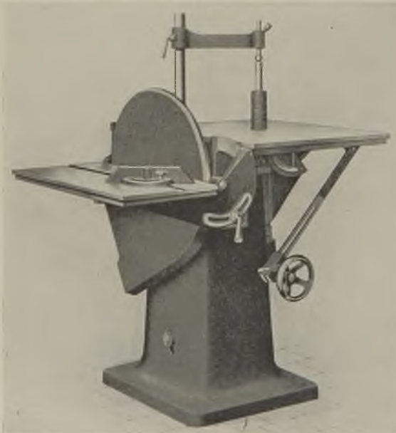
Abb. 884. Modellschleifmaschine mit einer Schleifscheibe und einer senkrechten Schleifwalze.
