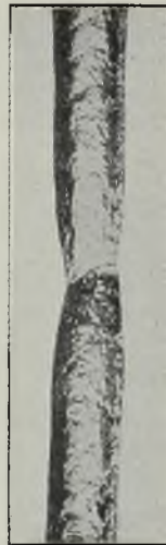
Abb. 620. Probestab mit 0,11% C, bei zu niedriger Temperatur (800°) gegläht.
