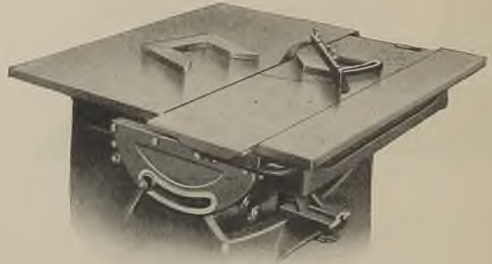
Abb. 865. Universal-Kreissäge eingestellt zum Schneiden von Gehrungen viereckiger Rahmen.
