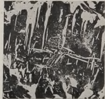
Abb. 569. Gußgefüge von Stahlguß mit 0,42% C. Vergr. 50.
