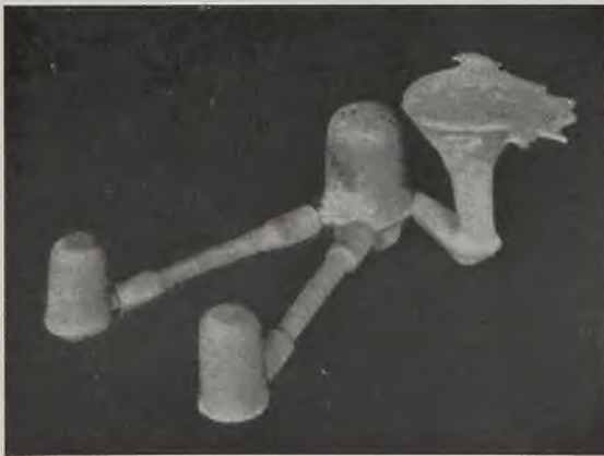
Abb. 405. Probestäbe mit Saugmasseln.
