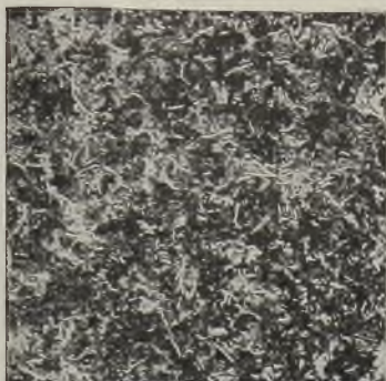
Abb. 573. Gußgefüge von Stahlguß mit 0,35% C. Ferrit I. Vergr. 50.
