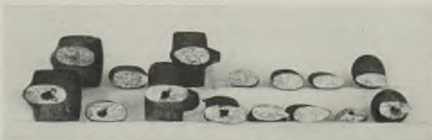
Abb. 407. Untere Reihe: Bruchstücke mit Lunker von Hebel a. Obere Reihe: Bruchstücke ohne Lunker von Hebel b.
