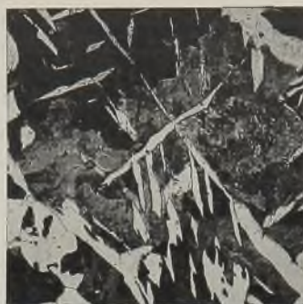
Abb. 593. Stahlguß mit 0,4% C, bei 1000° gegläht. Vergr. 100.
