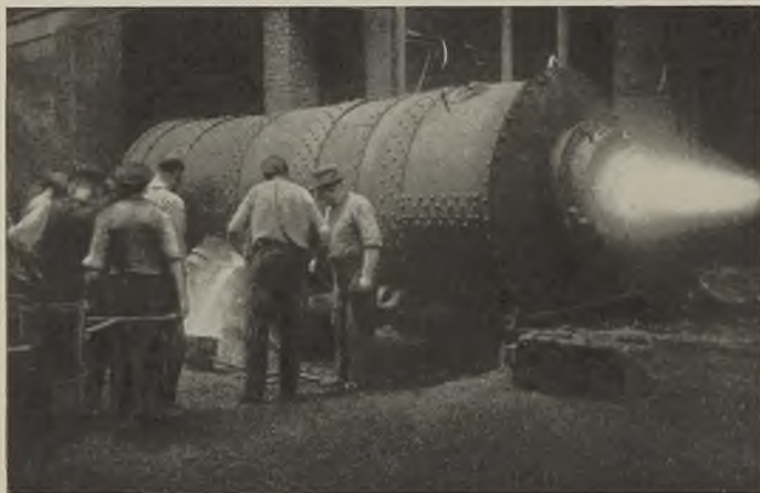
Abb. 398. Flammofen mit Kohlenstaubfeuerung für 3 t Fassung.
