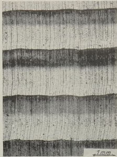
Abb. 752. Querschnitt durch Tannenholz. Vergr. 12.
