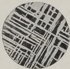
Abb. 570. Oben: Querschnitt parallel zur Würfelfläche (Tschermak). Unten: Gußgefüge in Stahlguß mit 0,55% C, Schnitt parallel zur Würfelfläche, Ätzung II. Vergr. 30 (Belaiew).
