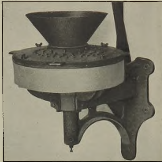
Abb. 702. An der Wand befestigte stehende Sandschleudermaschine.
