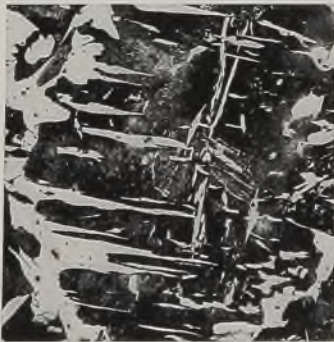
Abb. 590. Stahlguß mit 0,4% C, ungeglöh­t. Vergr. 100.
