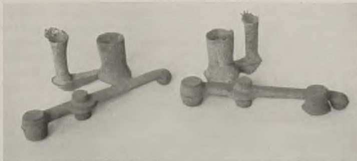
Abb. 406. Hebel. Links: a falsch angeschnitten; rechts: b richtig angeschnitten.
