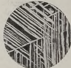
Abb. 572. Oben: Schnitt parallel zur Rhombendodekaederfläche (Tschermak). Unten: Wie Abb. 570, jedoch Schnitt parallel zur Rhombendodekaederfläche.
