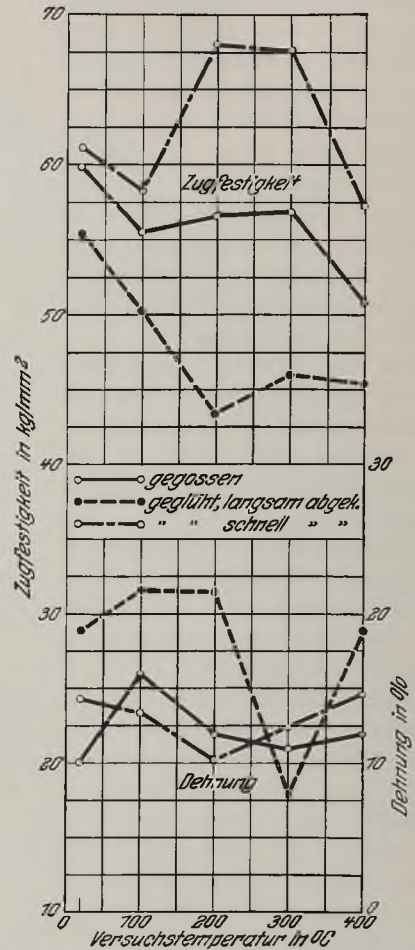
Abb. 605. Zugfestigkeit und Dehnung von Stahlguß in der Wärme. (Elektrostahl.)
