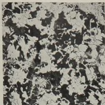
Abb. 592. Stahlguß mit 0,4% C, bei 800° gegläht. Vergr. 100.
