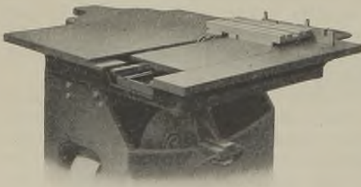
Abb. 868. Universal-Kreissäge eingestellt zum Schneiden von Nuten.
