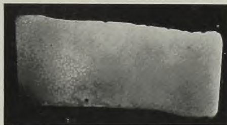
Abb. 644. Gute Warmschweißprobe im Schnitt (0,87fache Vergrößerung).
