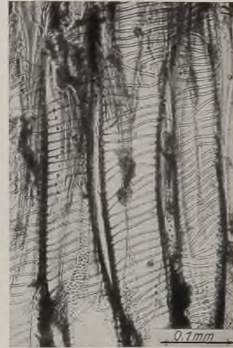
Abb. 756. Längsschnitt durch Lindenholz. Vergr. 150.
