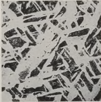
Abb. 568. Gußgefüge von Stahlguß mit 0,27% C. Vergr. 50.
