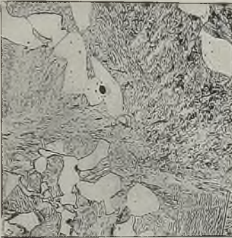
Abb. 579. Stahl mit 0,3% C auf 1100^\circ erhitzt, bei 840^\circ abgekühlt, dann abgeschreckt. Vergr. 225.
