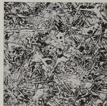
Abb. 591. Stahlguß mit 0,4% C, bei 730^{\circ} geg­löh­t. Vergr. 100.
