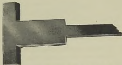
Abb. 808. Hobeisen für Wangenobel.
