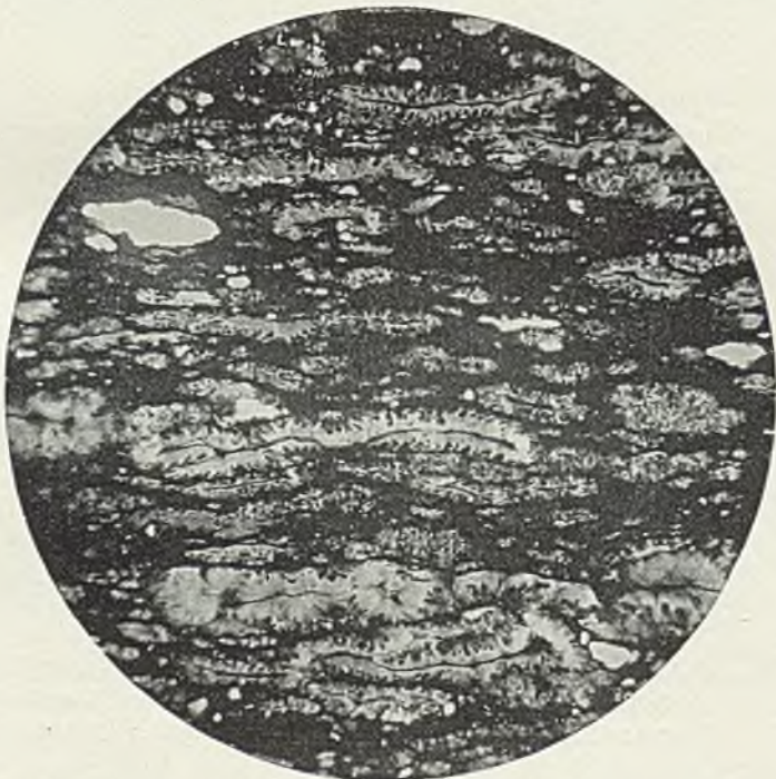
Fig. b. Sapanthron-Gestein („Kerosene shale“) von Blackheath westlich von Hartley in Australien. Schliff senkrecht zur Schichtungsfläche. \frac{75}{1} der natürl. Grösse. Die Algen („Reinschia australis“) sind zusammengesunken (bandförmig). — Nach einer von Potonié veröffentlichten Photographie von C. Eg. Bertrand.
