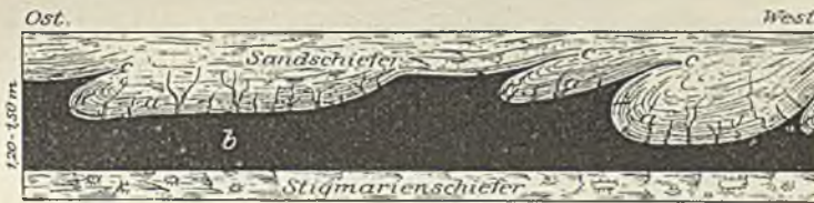
Fig. 49. Störung im Flöze Geitling der Zeche Humboldt in Westfalen durch wiederholtes Niedersetzen des Hangenden in das Flöz hinein (nach Kukuk). a = „Wilder Stein“, b = Flöz, c = „Rappen“.
