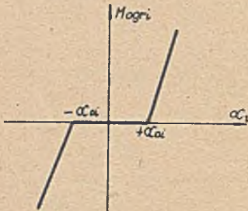
Rys. 4. Zależność momentu pochodzącego od ograniczników od wychylenia dźwigni
