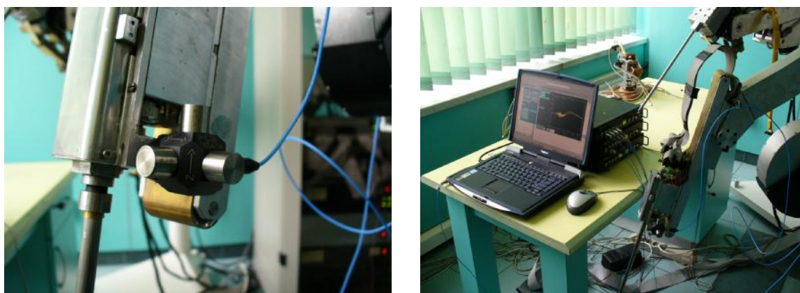
Rys.3. Stanowisko pomiarowe z rozmieszczonymi akcelerometrem
