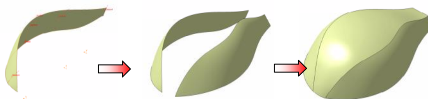
Rys.6 Etapy powstawania modelu powierzchniowego
