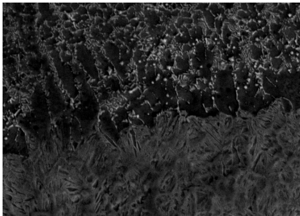
Fig. 4. 32CrMoV12-28 steel alloyed with TiC powder, SE SEM, mag. 1000x Rys. 4. Stal 32CrMoV12-28 stopowana proszkiem TiC moc lasera, SE SEM, powiększenie 1000x
