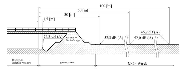
Fig. 4. Soil profile of the terrain MOP Wirek Rys. 4. Ukształtowanie terenu na MOP-ie Wirek
