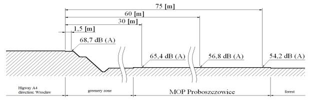
Fig. 3. Soil profile of the terrain MOP Proboszczowice Rys. 3. Ukształtowanie terenu na MOP-ie Proboszczowice
