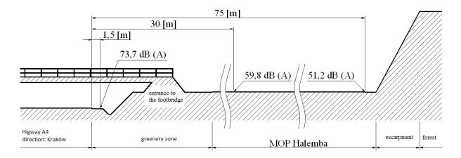
Fig. 5. Soil profile of the terrain MOP Halemba Rys. 5. Ukształtowanie terenu na MOP-ie Halemba
