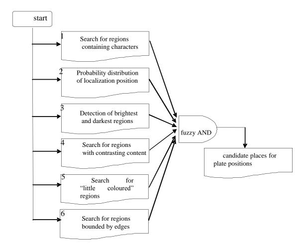
Fig. 1. Diagram of the license plate localization algorithm Rys. 1. Algorytm lokalizacji tablicy rejestracyjnej
