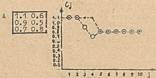
Rys.3. Dwie wersje sterowania A dla zadania I (wersja I - kropki, wersja II - kółka). Sytuacja na wykresie ilustruje przejście od montażu typu 1 do montażu typu 2. K=2, M=M_2=3 .
