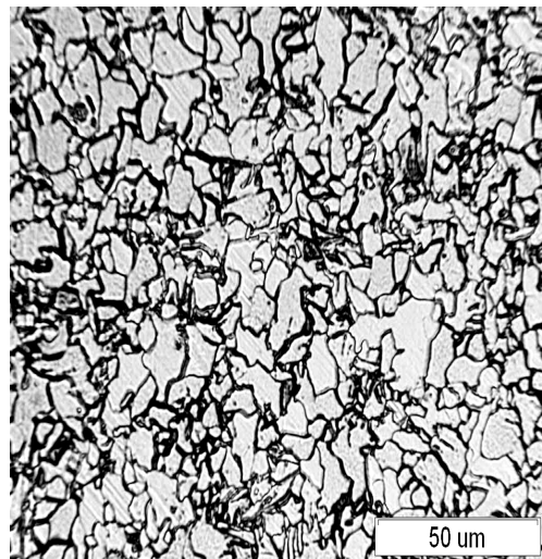
Fig. 16. Microstructure in HAZ Rys. 16. Mikrostruktura w SWC
