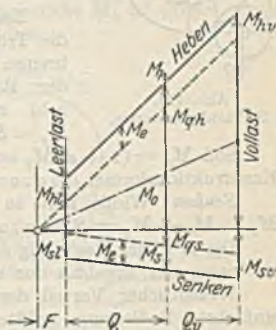
Abb. 112. Beziehung zwischen Momenten und Last bei selbsthemmenden Winden.
