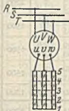
Abb. 169. Schaltung des Asynchronmotors mit Schleifringläufer.
