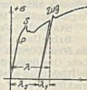
Abb. 177. Be- und Entlastungskurve bei Überschreitung der Streckgrenze.
