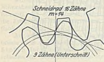
Abb. 132 u. 133. Unterschnittene und korrigierte Räder.
