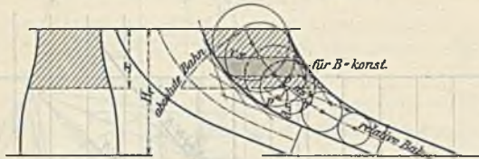
Abb. 66. Bestimmung des relativen und absoluten Wasserweges.
