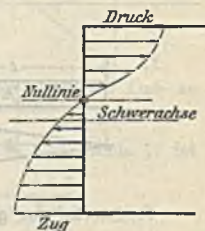
Abb. 28. Biegespannungen bei Gußeisen.
