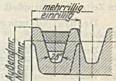
Abb. 206. Rille für Gliederkeilriemens.
