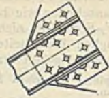
Abb. 27. └-Anschluß mit Hilfswinkeln.
