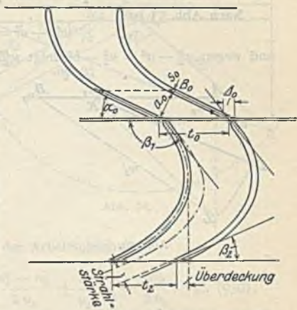
Abb. 49. Schaufelung der axialen Freistrahlturbine.
