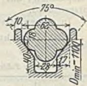
Abb. 238. Rille für Quadratseile.
