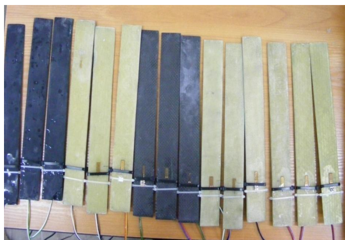
Rys. 4.1. Kompozytowe belki zastosowane do badań
