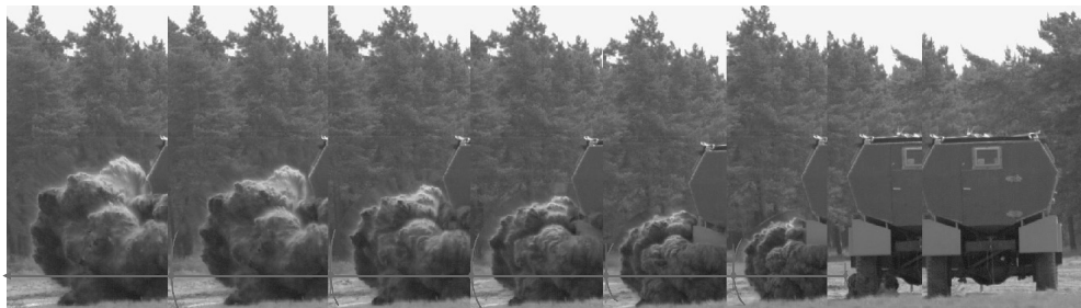
Rys. 8. Wyznaczanie prędkości czoła fali uderzeniowej wybuchu w trakcie eksplozji ładunku o masie 8 kg
