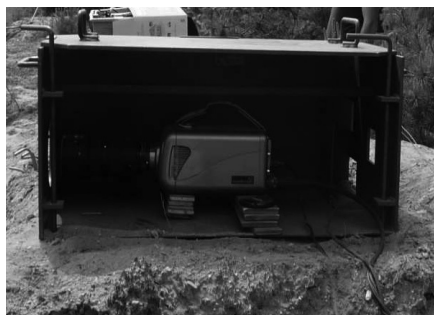
Rys. 7 Ultraszybka kamera optyczna na stanowisku pomiarowym
