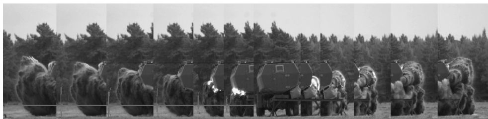
Rys. 9 Wyznaczanie prędkości czoła fali uderzeniowej wybuchu w trakcie eksplozji ładunku o masie 10 kg TNT pod kadłubem pojazdu
