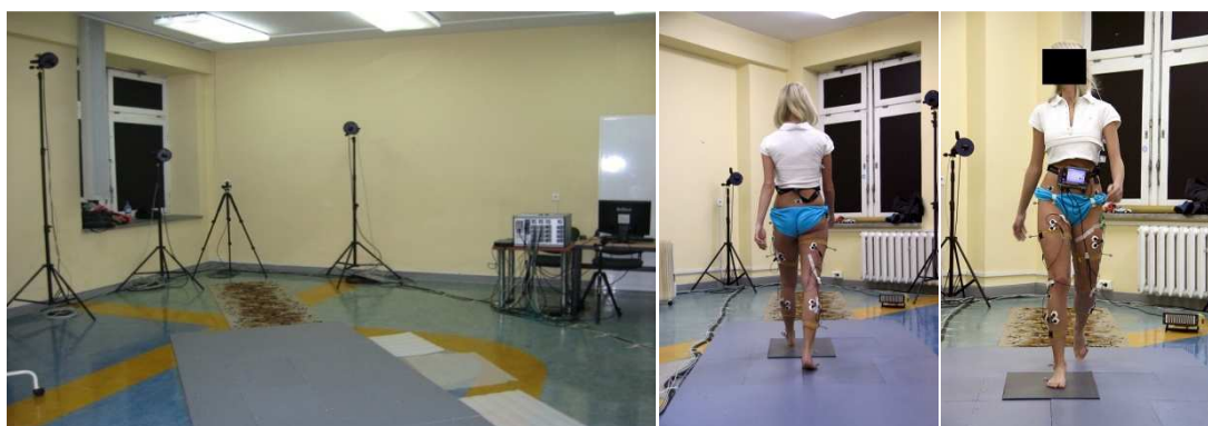
Rys. 1. System do trójwymiarowej analizy ruchu oraz osoba z naklejonymi markerami i elektrodami
