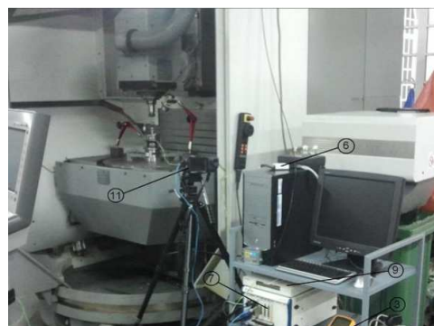
Rys. 2. Widok stanowiska do pomiaru oporów ruchu łożysk tocznych skośnych [2]; 1-czujnik siły osiowej, 3,6-urządzenia rejestrujące, 5,7,9-wzmocniacze sygnałów, 4-czujnik momentu, 8,11-czujniki temperatury PT-100, 10-pirometr, 11-kamera termowizyjna
