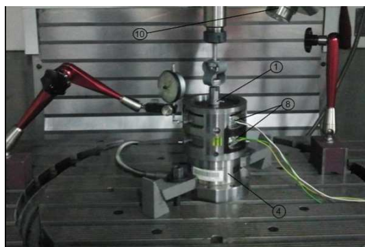
Rys. 2. Widok stanowiska do pomiaru oporów ruchu łożysk tocznych skośnych [2]; 1-czujnik siły osiowej, 3,6-urządzenia rejestrujące, 5,7,9-wzmocniacze sygnałów, 4-czujnik momentu, 8,11-czujniki temperatury PT-100, 10-pirometr, 11-kamera termowizyjna
