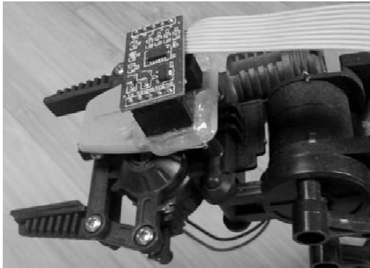
Rys. 2. Kiść manipulatora z zamocowanym czujnikiem akcelerometrycznym
