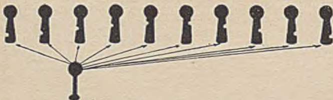
Bild 122. Hauptschlüssel-Profilstufung bei Chubbsschlössern
