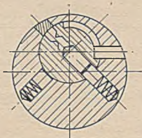
Bild 169. Anschlag am Zylinder
