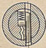
Bild 86. Zylinderschloßsystem nach Croning
