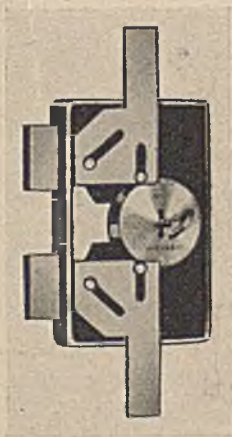
Bild 268. Riegelverschiebung durch Schubkurven
