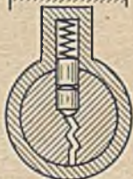
Bild 84. Zylinderschloßsystem nach Yale
