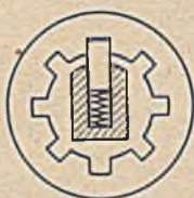
Bild 85. Sperrer greift von innen nach außen
