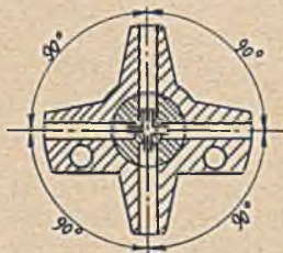
Bild 171. Sternschlüsselzylinder. Nach je 90^\circ Drehung ist der Schlüsselabzug möglich
