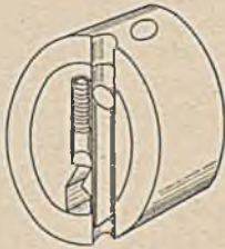
Bild 160. Schnitt durch den Croning-Zylinder
