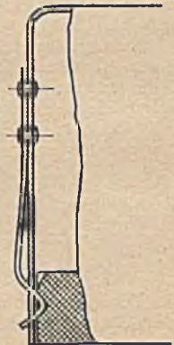
Bild 26. Durch- gedrückter Wulst als Schnäpper
