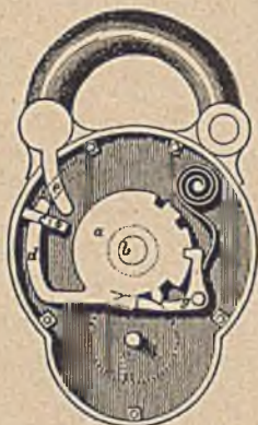
Bild 281. Vorhangschloß mit schließbarem Drehriegel
