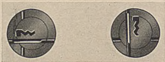
Bild 175. Zweifacher_Schlüsselabzug beim Crong-Zylinder
