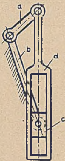
Bild 255. Schwingende Kurbel- schleife
