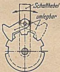
Bild 20. Klinkenschaltwerk mit umlegbarer Schaltklinke
