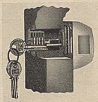
Bild 206. Kastenschloß in Verbindung mit einem Außenzylinder
