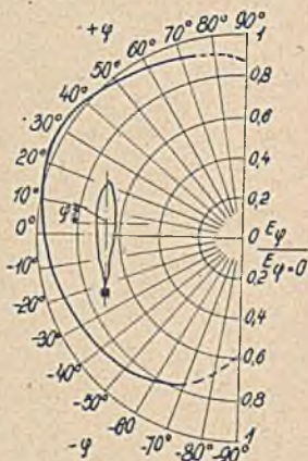
Bild 152. Darstellung der Wärmestrahlung einer frei im Raume brennenden Flamme eines Schweißbrenners im Kreisnetz.
