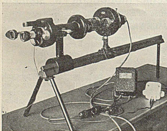
Rycyna 2. Polaryzacyjny fotometr Zeissa „Polaphot”.
