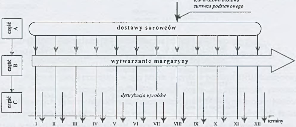
Rys. 2. Przebieg przepływu materiałowego w procesie produkcyjnym margaryny Fig. 2. Flow material run in margarine production process
