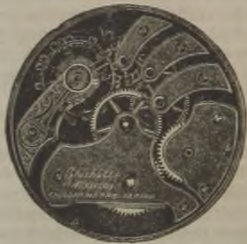
Abb. 15. Taschenuhrwerk mit Anfergang.
