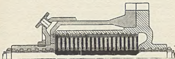
Abb. 60. Entwurf einer Gegendruckturbine für 100 at Anfangsdruck Bauart Lösel der ersten Brünner Maschinenfabrik-Aktiengesellschaft
