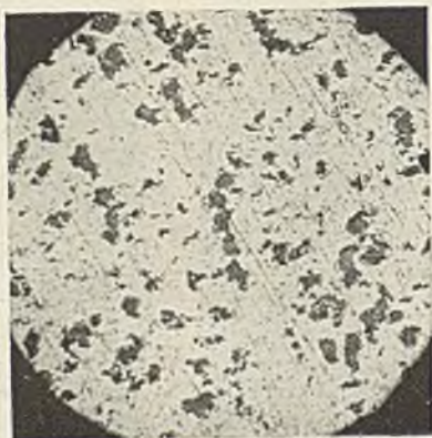
Abb. 29 Kleingefüge des Trommelbodens, 66 fache lineare Vergrößerung
