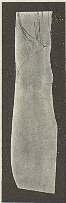
Abb. 28 Schweißstelle, unten Bodenstück oben Mantelstück
