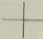
Fig. 6. Abbildung bei Einstellung der lichtempfindlichen Schicht in die Fläche der sagittalen Bildpunkte.
