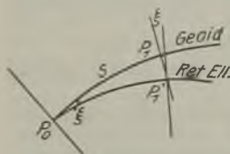
Fig. 2. Beziehung zwischen Geoid und Referenz-Ellipsoid.
