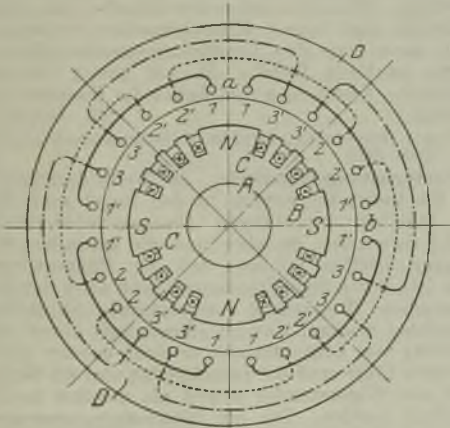
Aufbau eines vierpoligen Dreiphasen-Turbogenerators.
