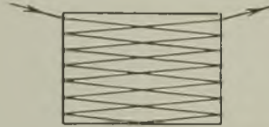
Fig. 2. Vielfache Reflexion zur Vergrößerung der Drehung.
