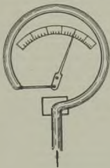
Fig. 5. Metallmanometer nach Bourdon.
