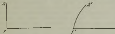
Fig. 3. Bildfeldwölbung. Eine achsensenkrechte Ebene, deren Durchschnitt XA ist, wird in einer krummen Fläche mit dem Durchschnitt X'A^* abgebildet.
