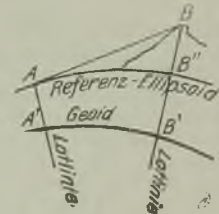
Fig. 1. Trigonometrische Höhenmessung. BB'' Höhe über dem Referenz-Ellipsoid. AA' und BB': Meereshöhen.
