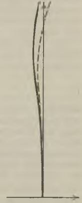
Fig. 4. Kurven der sagittalen und tangentialen Bildfeldwölbungen. — sagittale Bildfeldwölbungskurve. - - - tangentielle Bildfeldwölbungskurve.
