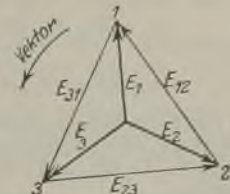
Fig. 5. Diagramm der verketteten und der Sternspannungen.
