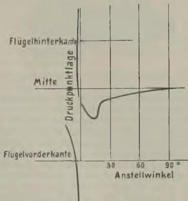
Druckpunkt beim Flugzeugflügel für verschiedene Anstellwinkel.
