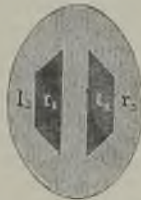
Fig. 8. Gesichtsfeld des Kontrastphotometers von Lummer und Brodhun im Moment der Einstellung.
