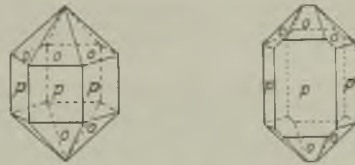
Fig. 1. Ideale und verzerrte Ausbildungsweise eines Quarzkristalles.
