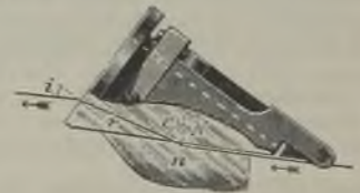
Fig. 10. Erzeugung der Grenzlinie der Totalreflexion im einfallenden Lichte.
