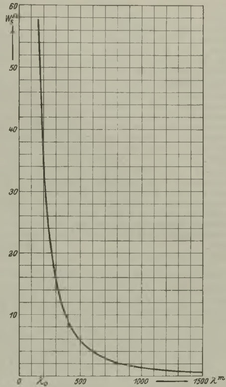
Strahlungskurve einer 50 m hohen Antenne.
