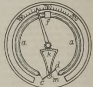
Fig. 3. Metallbarometer mit Bourdonscher Röhre.
