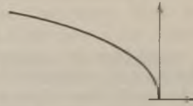
Fig. 1. Kurve der sphärischen Aberrationen eines sphärisch unterkorrigierten Objektivs.
