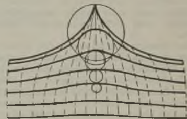
Fig. 1. Oberflächenwellen: Schnitt durch die Flächen gleichen Druckes.
