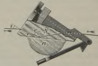
Fig. 9. Erzeugung der Grenzlinie der Totalreflexion im reflektierten Licht.
