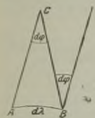
Fig. 1. Zur Berechnung des Foucaultschen Pendelversuchs.
