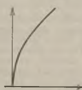
Fig. 2. Kurve der sphärischen Aberrationen eines sphärisch überkorrigierten Objektivs.
