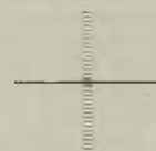
Fig. 7. Abbildung bei Einstellung der lichtempfindlichen Schicht in die Fläche der tangentialen Bildpunkte.
