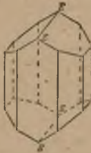
Fig. 3. Ein Kristall mit einer durch E E E E gehenden Spiegelebene. Augit.
