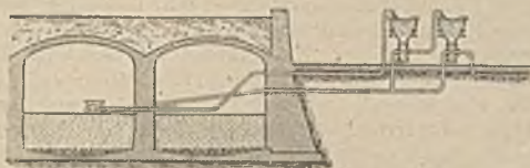
Fig. 66. Schema der Filterreinigung nach Bryan.
