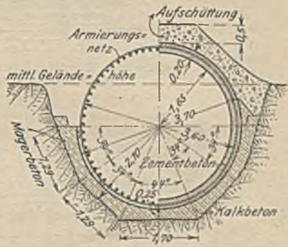
Fig. 17n. Eisenbetondruckrohr des Wasserkraftwerkes Champ a. Isère.
