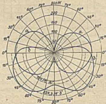
Fig. 377. a Glühlampe allein, b Glühlampe mit Reflektor, a' und b' zugehörige mittlere hemisphärische Lichtstärken.
