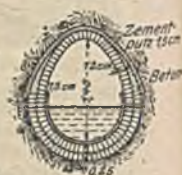
Fig. 17 e. Zuleitung für Dieppe.
