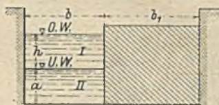
Fig. 67. b_1 = Wehrlänge + Summe der Zwischenpfeilerstärken.
