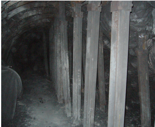
Rys. 10. Widok wzmocnienia obudowy chodnika 20a za frontem ściany w strefie oddziaływania krawędzi pokładu Fig. 10. The view of support reinforcement of roadway 20a behind longwall face in the range of impact of panel edge
