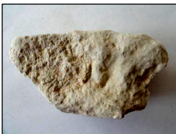
Rys. 9. Kremowy wapień biohermowy z okolicy Rhoufi Fig. 9. Crème biohermal limestone from the Rhoufi area
