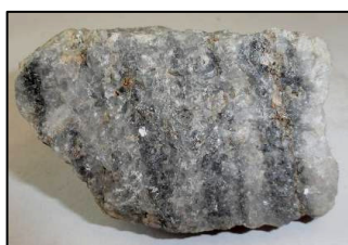
Rys. 23. Szary marmur z widoczną laminacją Fig. 23. Grey marble with visible lamination
