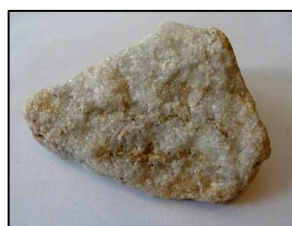
Rys. 24. Marmur zbudowany głównie z białych blastów kalcytu Fig. 24. White marble built mainly of white calcite blasts
