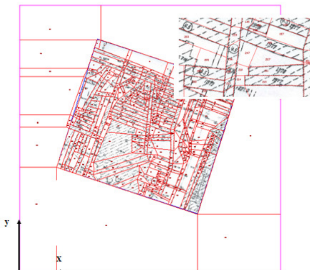
Rys. 2. Widok archiwalnej mapy wyrobisk górniczych w warstwie rudy z podziałem na parcele Fig. 2. The view of archival map of mining excavations in the layer of ore divided into parcels
