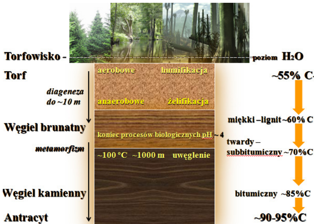
Rys. 2. Schemat przedstawiający przebieg procesów humifikacji, żelifikacji oraz uwęglania, powodujących wzrost zawartości pierwiastka C
