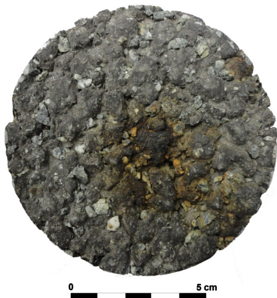
Fot. 1. Rdzeń z nawierzchni, widok z góry Phot. 1. Core from the asphalt pavement, from the top
