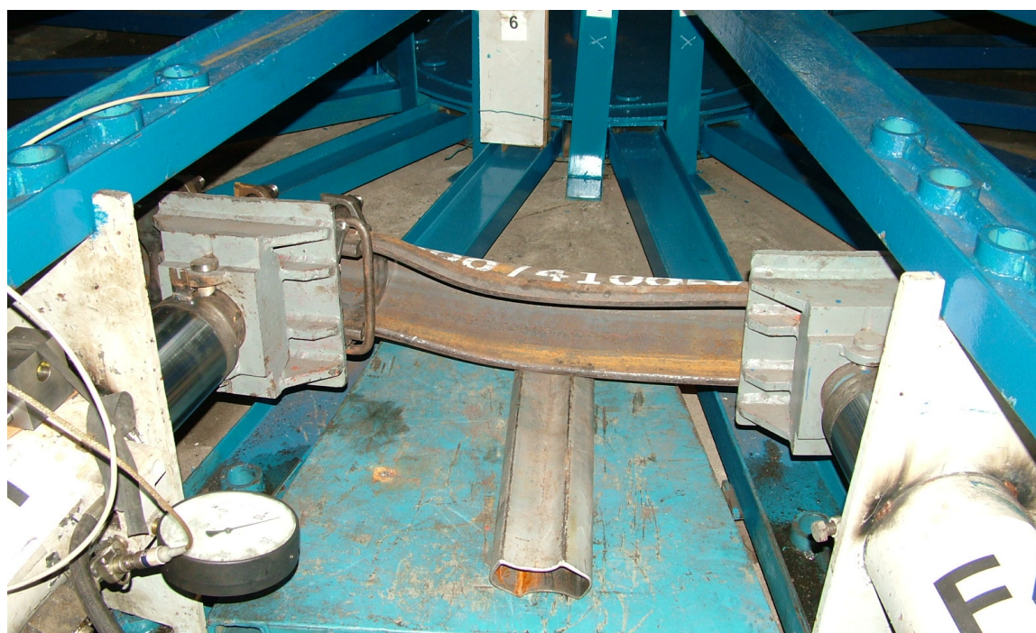
Rys. 8. Deformacja plastyczna łuku stropnicowego przy obciążeniu maksymalnym 1355 kN – badanie 07, widok od strony zewnętrznej
