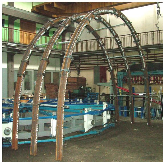
Rys. 2. Ogólny widok odrzvi obudowy OŁE6/V36/5,5 m x 4,1 m po ich zabudowie w laboratorium
