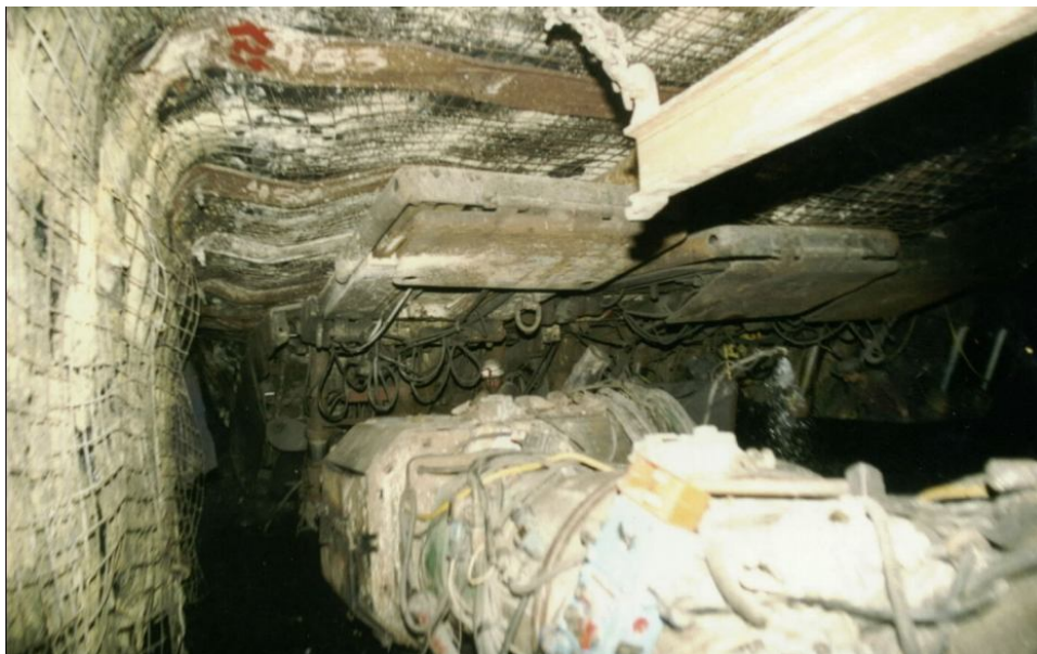
Rys. 4. Widok skrzyżowania ściana-chodnik w obudowie kotwiowej z sekcjami wychodzącymi do chodnika (fot. P. Głuch)
