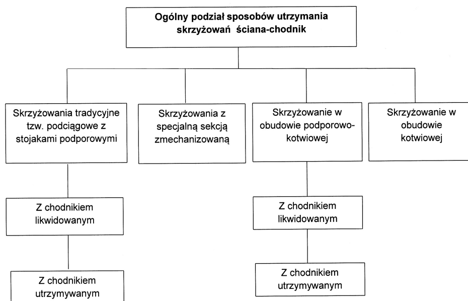
Rys. 1. Schemat blokowy sposobów utrzymywania skrzyżowań ściana-chodnik Fig. 1. Methods of maintenance of crossing longwall and heading
