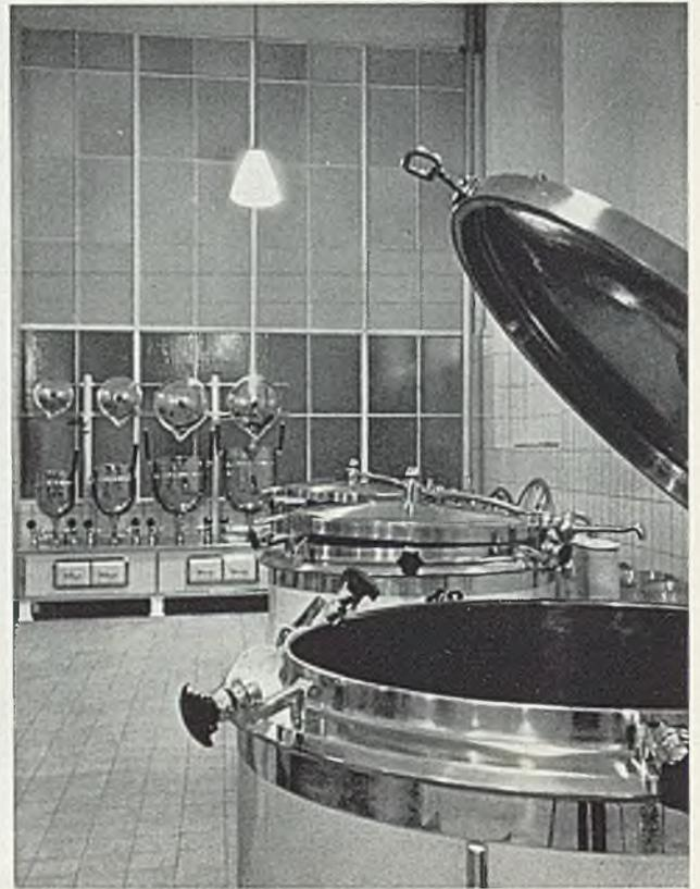
Abb. 53 Kochkessel und Kippkessel in einer Großküchenanlage
