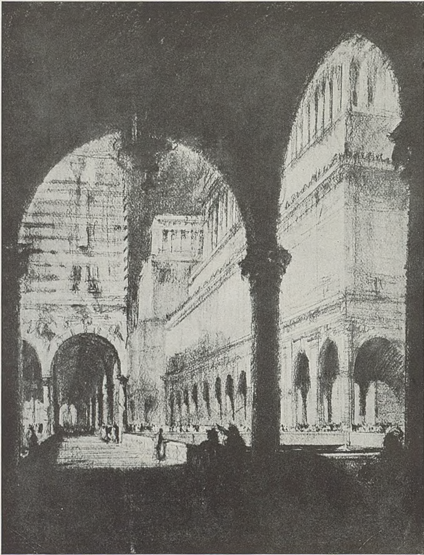
ABB. 173. — NEW YORK. VORSCHLAG ZUR LÖSUNG DER VERKEHRSSCHWIERIGKEITEN Architekten: Der Architekten-Ausschuß unter Leitung von Harvey W. Corbett. Verlegung der Bürgersteige in das zweite Geschöß der Häuser. Vgl. Abb. 168.
