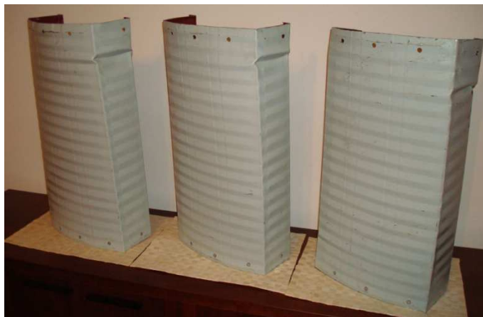
Rysunek 15. Zdeformowane próbki paneli pofałdowanych
