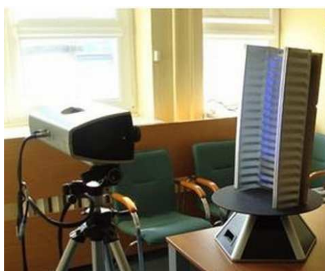
Rysunek 16. Skaner 3D wraz z podwójnie giętym panelem
