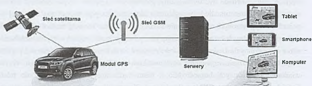
Rys. 3. Schemat działania monitoringu pojazdów. Źródło: www.gpsnadzor.pl/monitoring-pojazdow Fig. 3. Vehicle monitoring system scheme. Source: www.gpsnadzor.pl/monitoring-pojazdow
