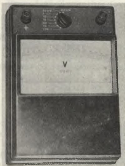
Fot. 1. Miliwoltomierz magnetoelektryczny klasy 0,2 typu PK-2
