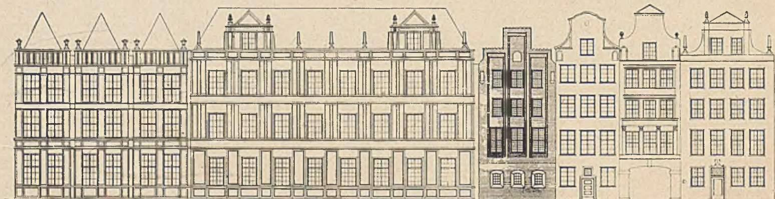
RYS. 563. ROZWINIĘCIE UL. OGARNEJ Z ALTERNATYWĄ ROZWIĄZANIA POŁUDNIOWEJ ELEWACJI GMACHU POCZTY PO LEWEJ STRONIE 1 : 400
