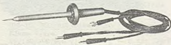
Fot. 10. Sonda pomiarowa do miernika typu UM-7T
