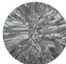
Rys. 9. Makrostruktura próbki 01. Próbka modyfikowana (200Ti + 40B)[ppm]. Fig. 9. Macrostructure of sample number 01. Casting with inoculation (200Ti + 40B)[ppm].
