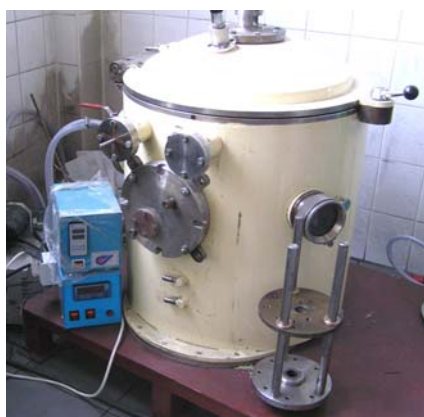
Rys. 2. Widok i schemat stanowiska stosowanego do odgazowania i homogenizacji zawiesin kompozytowych: 1-napęd, 2-oś mieszadła i system jego mocowania, 3- komora próżniowa, 4-piec oporowy, 5-mieszadło grafitowe, 6- zawiesina kompozytowa
