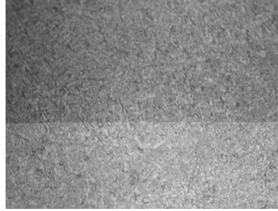
Rys.6. Drobnziarnista struktura napoiwy z żeliwa stopowego chromowego – ferryt oraz eutektyka węglkowa (ferryt + M_7C_3 ). Pow. 600x, traw. Nital.
