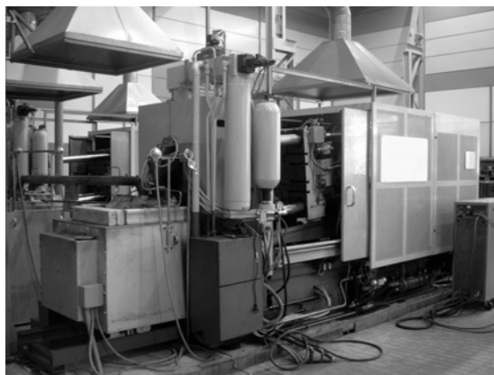
Rys. 3. Gorąco-komorowa maszyna odlewnicza Fig. 3. Hot-chamber die casting machine
