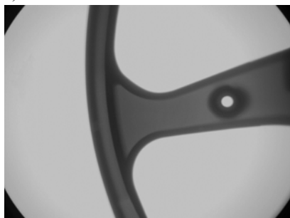
Rys. 6. Zdjęcie rentgenowskie odlewu, a) dobry, b) wadliwy
