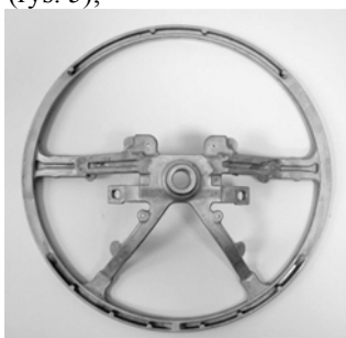
Rys. 4. Odlew szkieletu kierownicy wykonany ze stopu AM50
