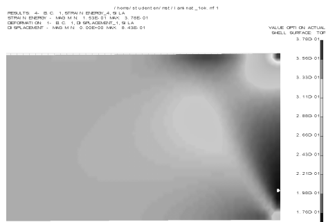
Rys. 4. Rozkład energii naprężeń w kompozycie CFRP o kącie ułożenia włókien 60^\circ względem rozciągającej siły.
