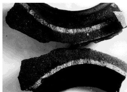
Rys. 2. Przelomy wzdłużne korpusu pompy Fig. 2. Lengthwise fractures of the pump body
