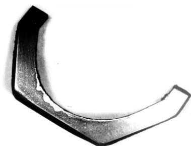
Rys. 8. Przekrój rolki z widoczną warstwą kompozytową Fig. 8. Core from driving shaft mould
