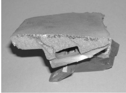
Rys. 4. Przełom lemiesza z widoczną powierzchnią warstwą kompozytową Fig. 4. Fracture of share with surface composite layer
